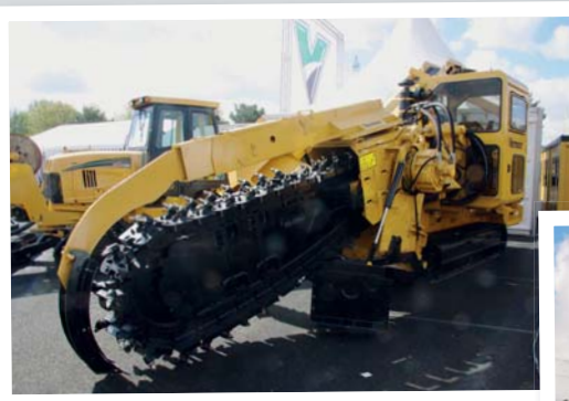
Kedjegrävaren T558 från amerikanska Vermeer gräver ner till 1,8 meter djupa diken.
