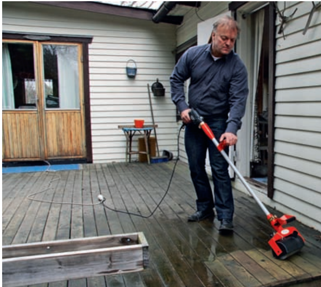
Bengt Liljedahls roterande rotborste påminner om en gammaldags handdriven mattdammsugare och är skonsam mot mjukt trävirke.
