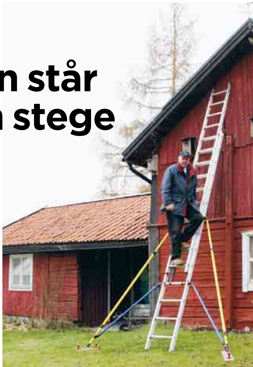
Torsten Jonssons diagonalstöta får stegen att stå stadigt utan att glida eller välta i sidled. Stegen hindras också från att börja gunga.
