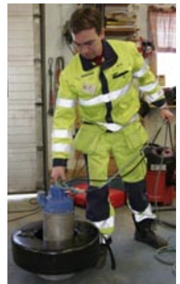
Johan Markströms flytkorg påminner om ett reservhjul. Dränkpumpen placeras i ett nedsänkt nav. I botten finns en korg av perforerad plåt som hindrar att grova partiklar sugts in.
