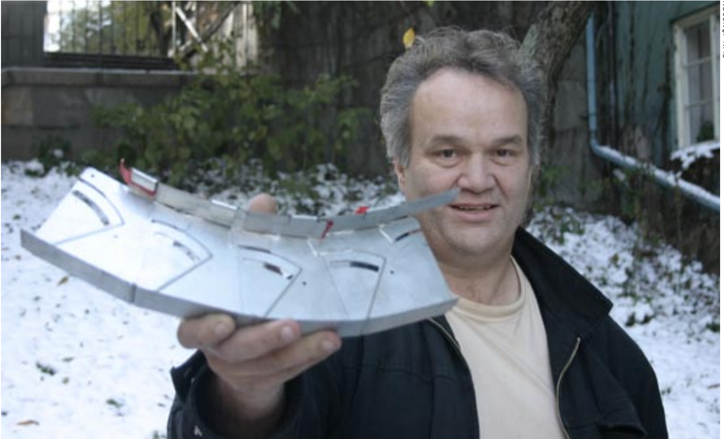
Krister Edlund har konstruerat en u-balk som är lätt att böja. Den kan användas både som balk och som regel.
