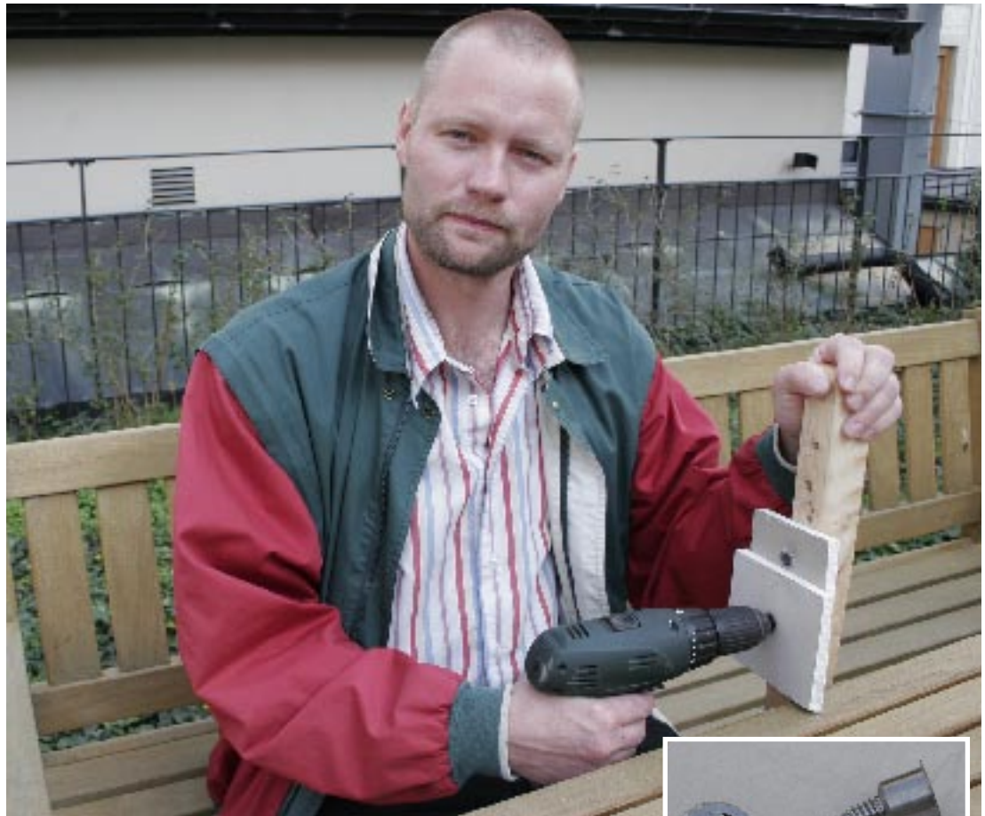
Per Karlssons gipsskruv är en variant av teleskopskruv som ligger inne i en hylsa. Hela paketet får plats i gipsskivan. När skruven dras i blir den så lång att den klarar av att fästa även dubbla lager av gips.
