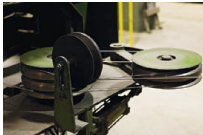
2 Valstråden dras till rätt dimension. Densiteten ökar och tråden får så småningom rätt dimension.
