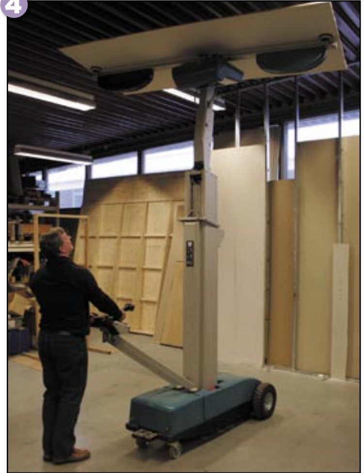
1. Vagnen fälls upp så att gipslasten går igenom en dörröppning. 2. Skivorna tippas över på en kassettvagn och placeras i rätt läge för monteringen. 3. I trånga utrymmen används en monteringsvagn. 4. Monteringsroboten styrs med joystick-spakar och klarar höjder upp till 3,6 meter.
