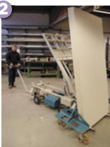
1. Vagnen fälls upp så att gipslasten går igenom en dörröppning. 2. Skivorna tippas över på en kassettvagn och placeras i rätt läge för monteringen. 3. I trånga utrymmen används en monteringsvagn. 4. Monteringsroboten styrs med joystick-spakar och klarar höjder upp till 3,6 meter.
