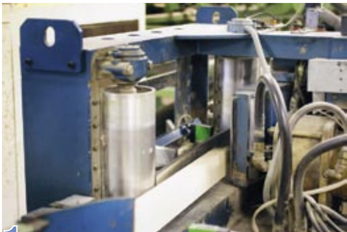
1. Vid den första maskinen beräknas hållfastheten och därefter sorteras virket in i olika kvalitetsklasser.
