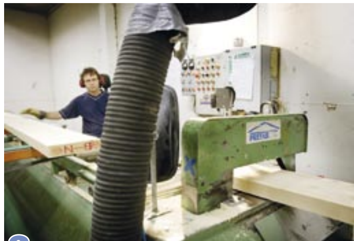
2. Virket måste vara kvistfritt de sista fem centimetrarna för att inte skarven ska riskera att bli försvagad. Ändar med kvistar kapas därför bort vid behov.
