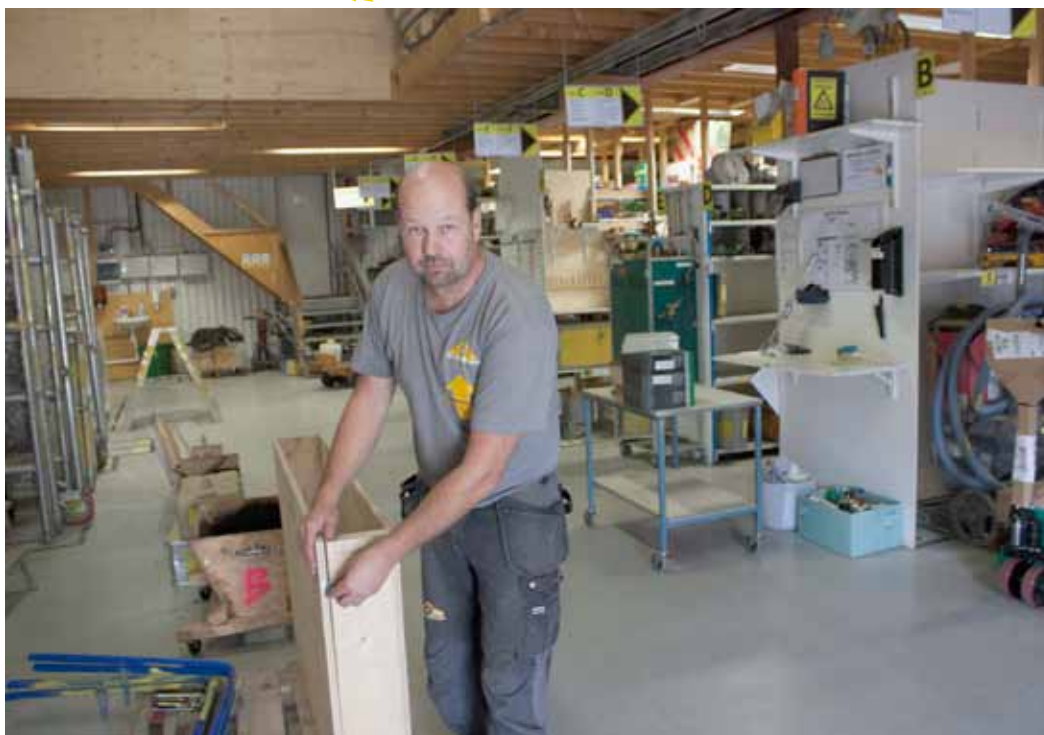
Nic Lundgren ser till att allt i förrådet ligger på sin plats och att det inte är tomt hyllorna. Skärlåda för mineralull används som en geringslåda.
