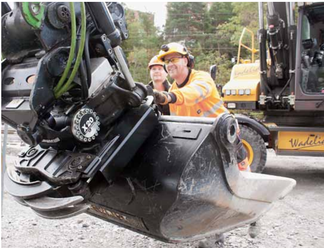
På maskinföraren Denny Jirbrinks (till vänster) grävmaskin sitter ett skoplås från Steelwrist, där skopan inte kan lossna från maskinen. Här jobbar han tillsammans med anläggningsarbetaren Marek Kuningas.
