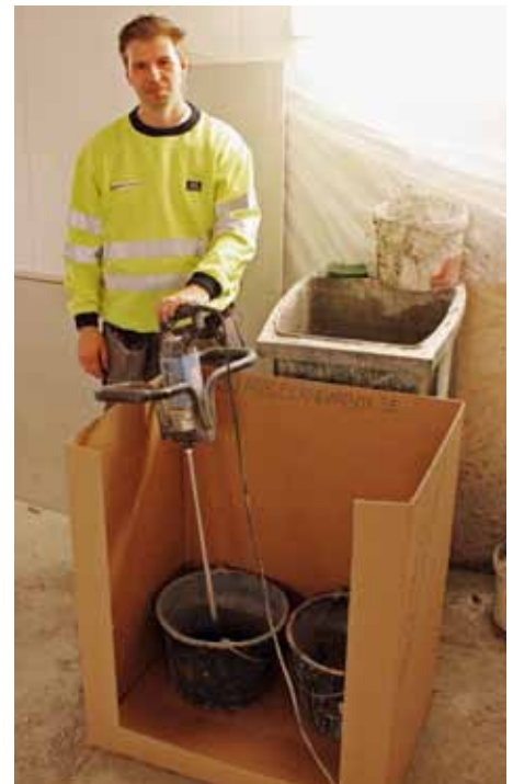
På blandarboxens ena sida finns en utstansad skiva som tas loss och används som golv. Blandaren kan stå kvar inuti lådan när den inte används.
