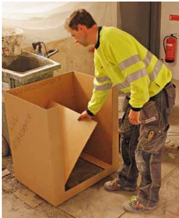
På blandarboxens ena sida finns en utstansad skiva som tas loss och används som golv. Blandaren kan stå kvar inuti lådan när den inte används.
