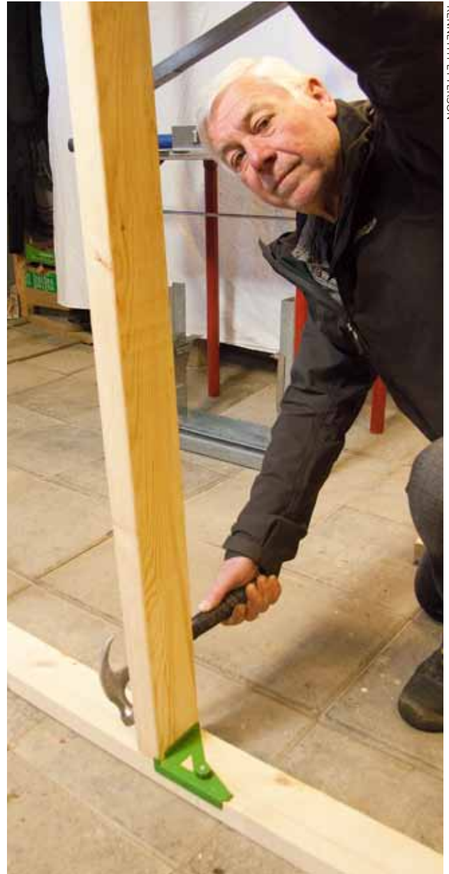
Tack vare Kjell Wengruds stöd slipper man fästa klossar på andra sidan brädan när man spikar.
