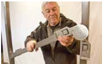
Monteringsstödet för plåtreglar har magneter och gradskiva.
