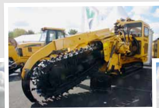
Kedjegravaren T558 från amerikanska Vermeer gräver ner till 1,8 meter djupa diken.
