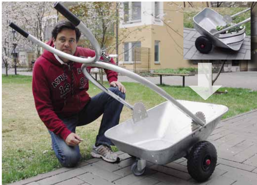
När lasten tippats vrids handtaget tillbaka så kärran används som en traditionell skottkärra. Johan Sandberg fick idén när han beställde jord.
