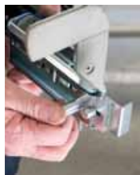
Det vändbara munstycket anpassas för synliga respektive dolda karmhå.
