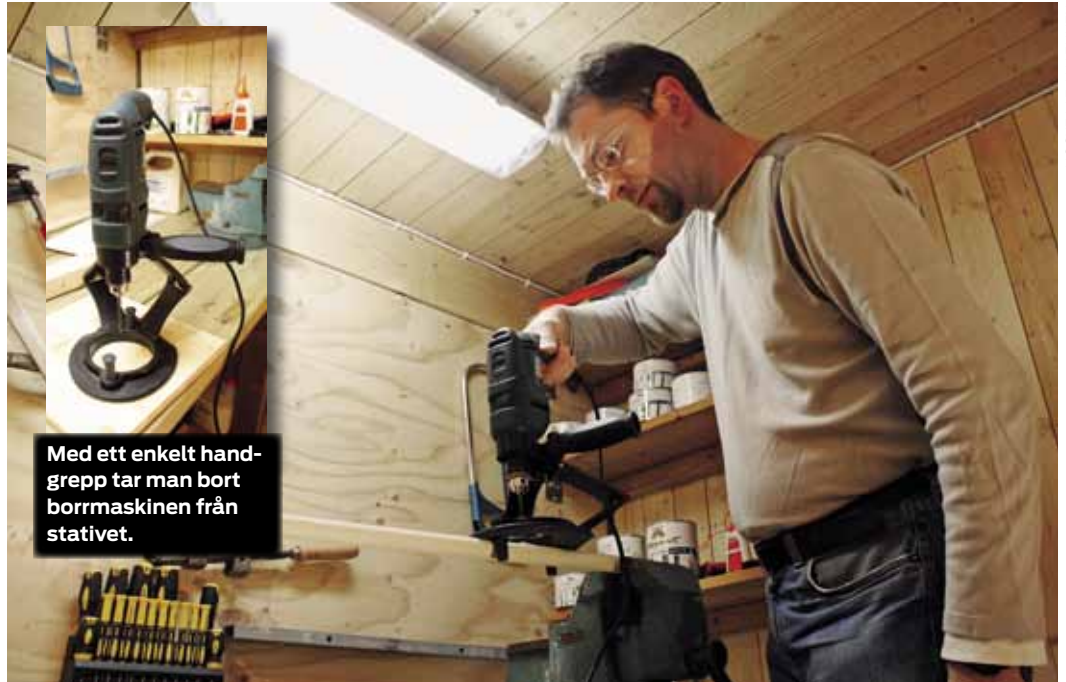
Anders Ljungberg visar hur styripinnarna centrerar och låser fast vid borrar i en rundstav.
