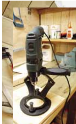
Med ett enkelt handgrepp tar man bort bormaskinen från stativet.
