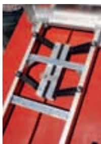
Gummiklädda skenor griper tag i falsen. Ju tyngre belastning, desto hårdare griper de fast.
