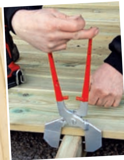
Dag Melanders tång kläms fast genom att de övre stiften pressas in i virket. Sedan pressar man trallbrädan lätt inåt och fixerar brädan med de kortare stiften.
