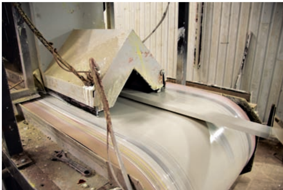
Bergslagspanel stryks redan i fabriken med två lager färg.
