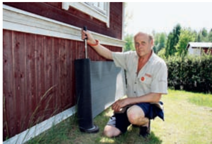
Leif Rundlöfs rullstativ underlättar vid montering av papp på tak och väggar.
