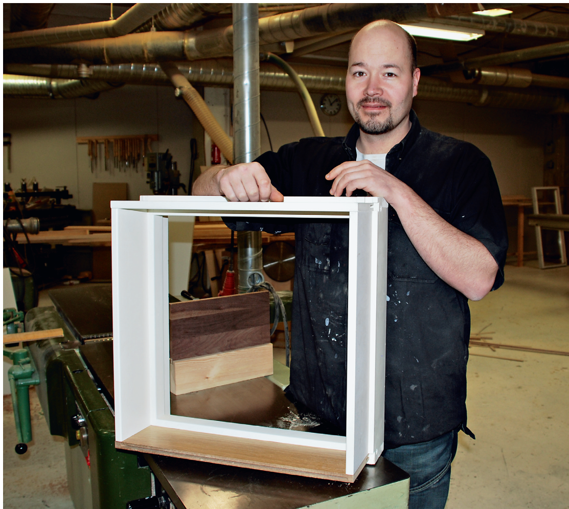
Med Jens Karlssons uppfinning tar det inte många minuter att montera ihop en smyg. Eftersom smyg och fönster är kilade i varandra så blir det aldrig några glipor.
