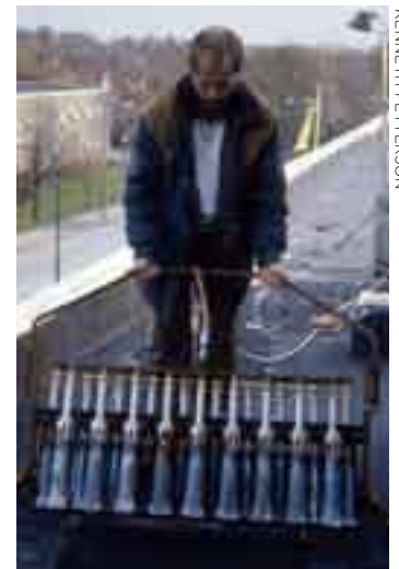
Den eldrivna varmluftsmaskinen smälter och pressar samman fogarna i samma moment. Fem centimeter breda skarvar räcker.
