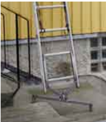
Den breda foten hindrar stegen från att rotera i trappan.
