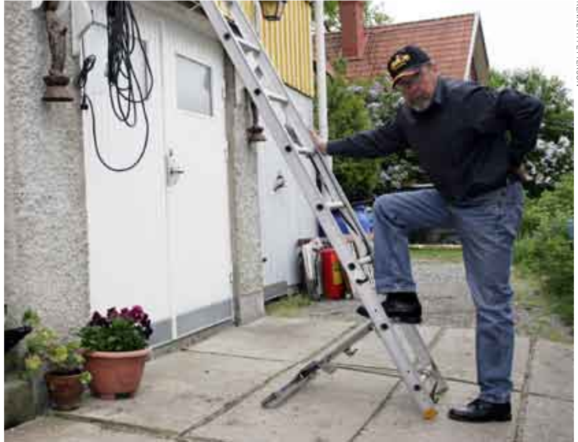
Håkan Westerbergs stegfot träs på en vanlig standardstege av aluminium. Här är foten monterad så att den hindrar stegen att glida. Då fixeras den med en spännrem runt nedersta stegpinnen.
