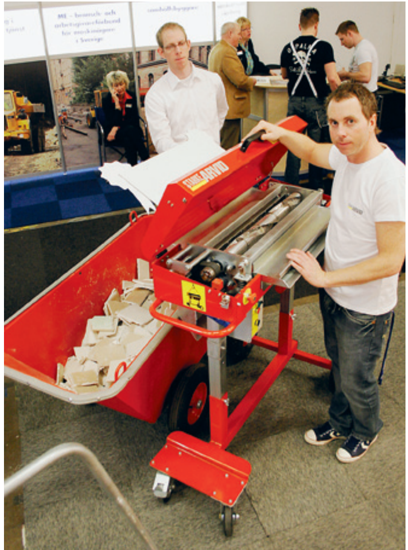
Starke Arvids gipsklippare har en roterande kniv som påminner om en gräsklippare. Den förvandlar spillet till decimeterstora bitar.
