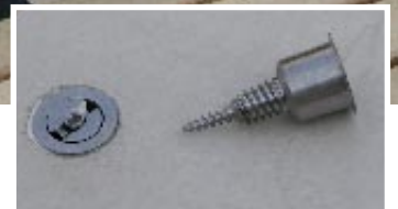
Per Karlssons gipsskruv är en variant av teleskopskruv som ligger inne i en hylsa. Hela paketet får plats i gipsskivan. När skruven dras i blir den så lång att den klarar av att fästa även dubbla lager av gips.
