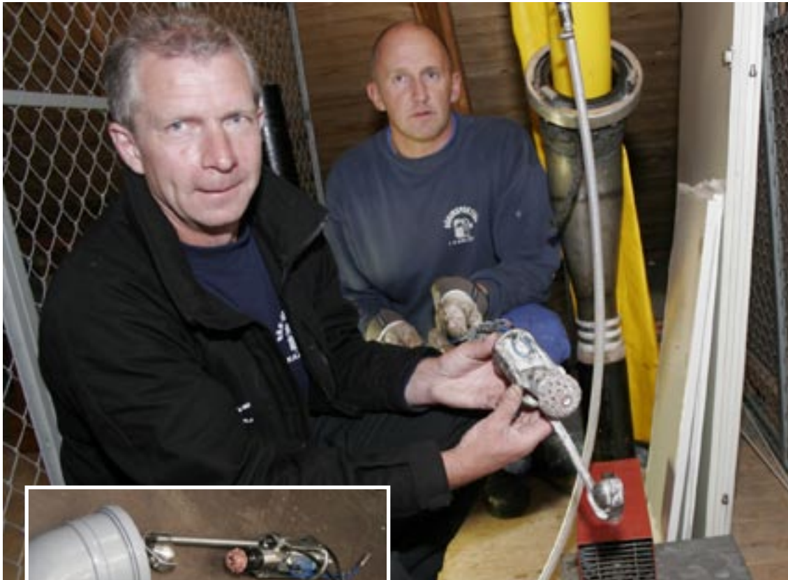
Ulf Larssons specialfräs påminner en om stor tandläkarbör och fjärrstyrs via en monitor på upp till 15 meter från arbetsstället. Fräsen klarar 90-graders rörvinklar. Från vindsvåningen arbetar Ingemar Magnusson med att ge rören nytt innerhölje av epoxi.
