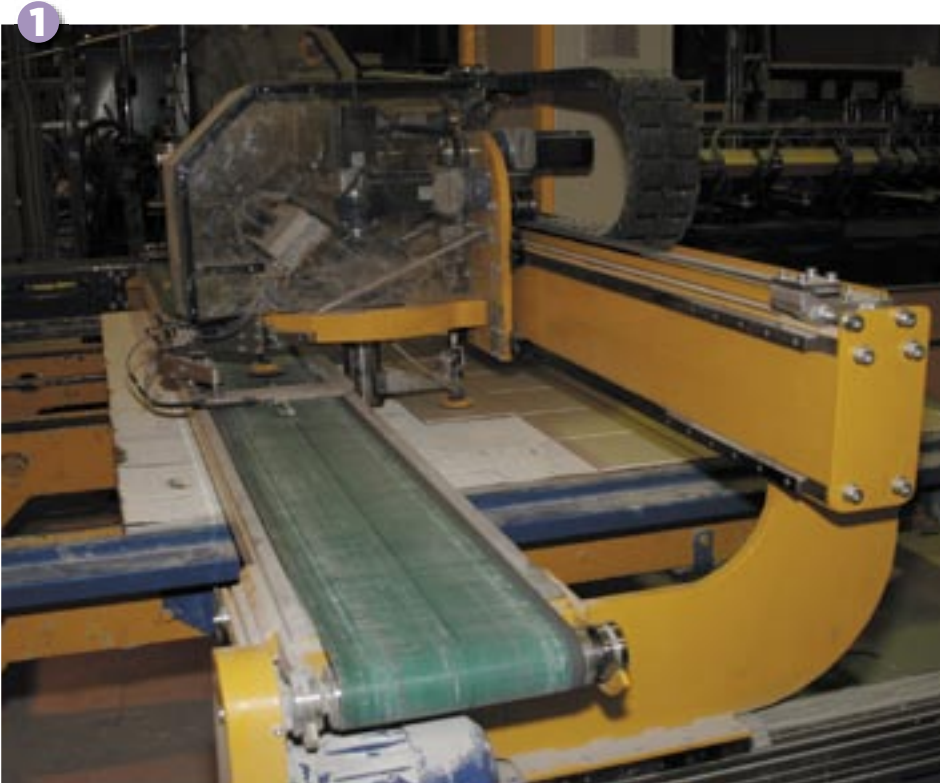
1. Maskinen sätter en kakelplatta var tredje sekund. 2. Fogning görs fortfarande manuellt, men snart tar maskinen över. 3. Badrummets golv gjuts i formar som vänds efter en natts härdning. Även golvklinker kommer snart att sättas maskinellt hos badrumstillverkaren Partab i Kalix.
