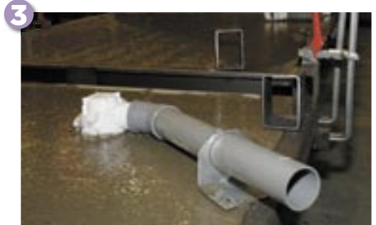
1. Maskinen sätter en kakelplatta var tredje sekund. 2. Fogning görs fortfarande manuellt, men snart tar maskinen över. 3. Badrummets golv gjuts i formar som vänds efter en natts härdning. Även golvklinker kommer snart att sättas maskinellt hos badrumstillverkaren Partab i Kalix.
